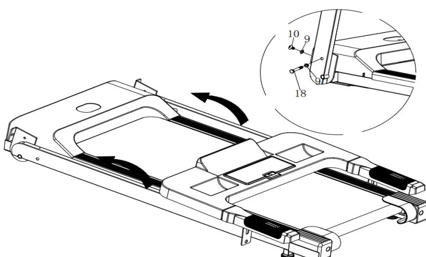
**SCHRITT 2:** Verwenden Sie die M8x12 Schrauben (10) und die Beilegscheiben (9), um die Konsole, wie auf dem Bild unterhalb beschrieben, an den Frontstützen zu befestigen
