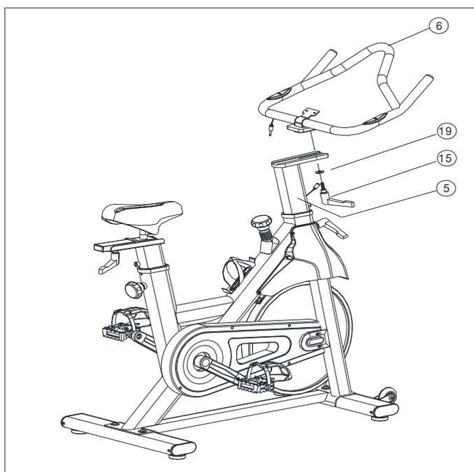
**FASE 6:** Per prima cosa posizionare il computer (9) sull'apposita piastra sul manubrio (6) e utilizzare le viti (10) per fissarlo; A (18) è collegato alla linea di induzione B (22) e il C (23) è collegato alla linea di induzione D (24) e le interfacce sono corrispondenti.
